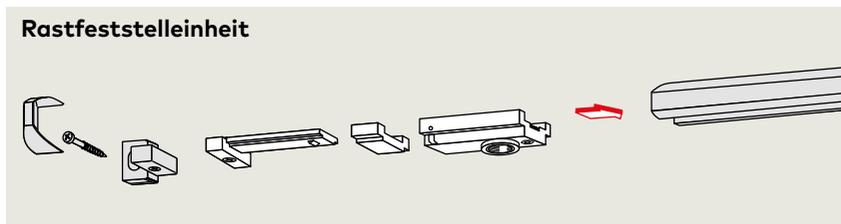
Die Rastfeststelleinheit ermöglicht ein exaktes Feststellen von Türen ohne Rückfederung bis zu einem Öffnungswinkel von ca. 145°. Die Rastfeststelleinheit ist
