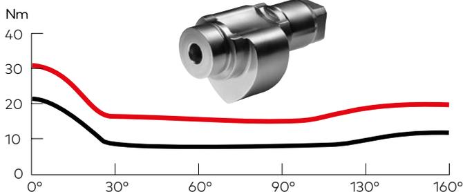
Die herzförmige Nockenscheibe und der Lineartrieb des TS 90 Impulse sorgen für eine leichte Betätigung der Tür durch ein stark abfallendes Öffnungsmoment. So haben selbst Kinder, alte Menschen und Behinderte keine Mühe mehr, Türen zu öffnen.
