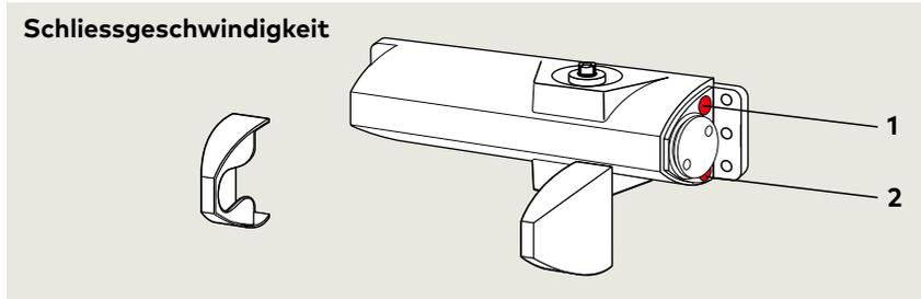
Die Schliessgeschwindigkeit des TS 90 Impulse ist über Ventile in zwei voneinander unabhängigen Bereichen stufenlos einstellbar.
